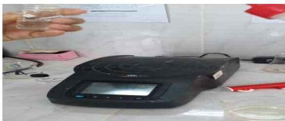
Figure 20: Spectrophotomètre UV visible utilisé pour la détermination du taux des nitrates
