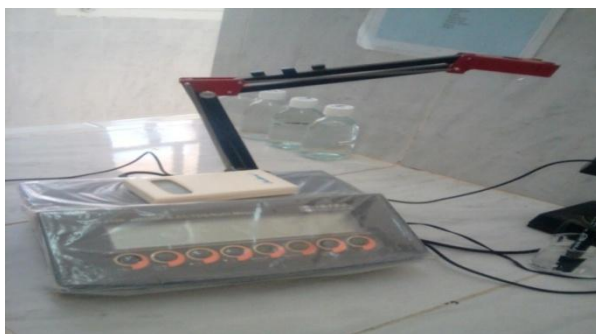
Figure 15 : l'appareille multi- paramètre (HI 2550 pH/ORP et EC/TDS/NaCLMeter de marque Huch) .
