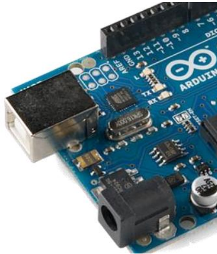
FigII 2 : la connexion USB d'un Arduino
