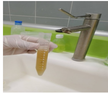
2- Remplir un tube conique au deux tiers avec la dilution au formol à 10%
