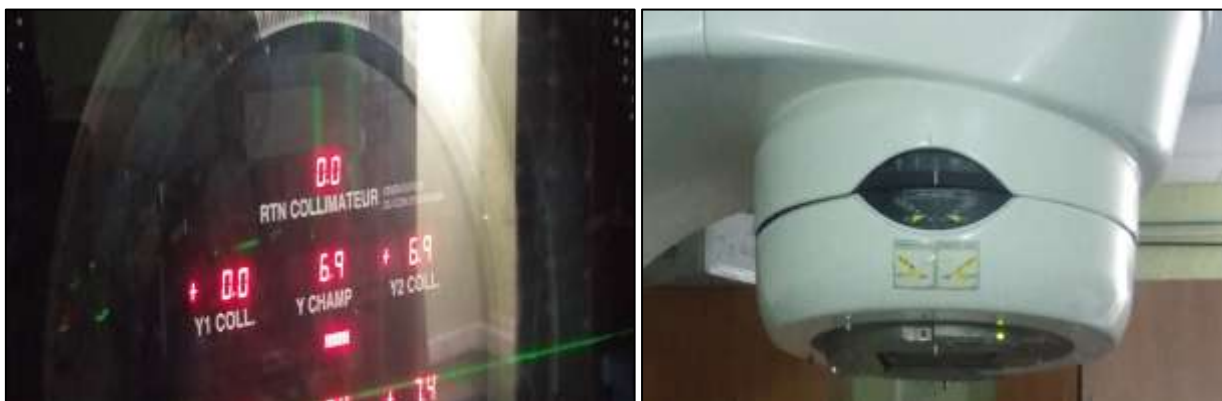
Figure III-3 : Condition de mesure de contrôle d'angle du collimateur.
