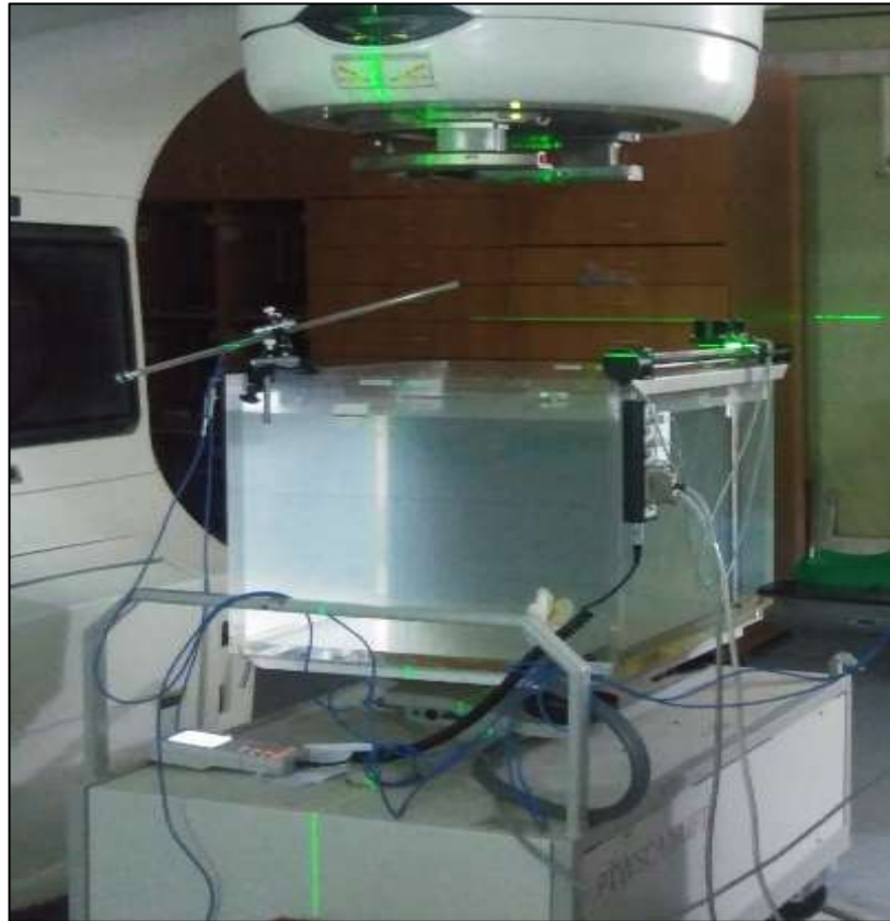
Figure III-18 : Cuve à eau en cours de montage (CAC Ouargla).
