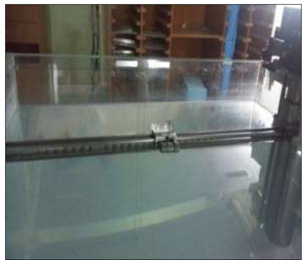
Figure III-10: Cuve à eau de type PTW MP3. Figure III-11: Moteur piloté pour le déplacement de la Chambre d'ionisation (CAC Ouargla).
