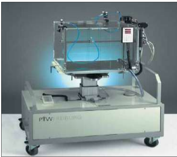
Figure III-10: Cuve à eau de type PTW MP3. Figure III-11: Moteur piloté pour le déplacement de la Chambre d'ionisation (CAC Ouargla).
