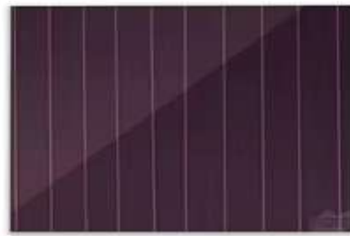
Figure I.4 Cellule Silicium amorphe en couche mince
