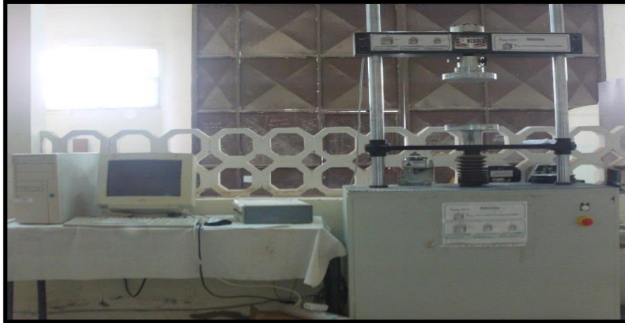
Figure II.14 : Machine utilisée pour la mesure des résistances mécaniques
