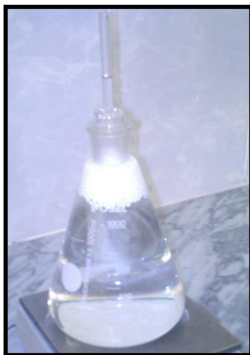
Figure II.11 : Pycnomètre rempli d'eau + échantillon.
