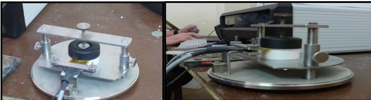
Figure II.22 : Schéma de la sonde TPS (mesure caractéristiques thermiques du polystyrène).
