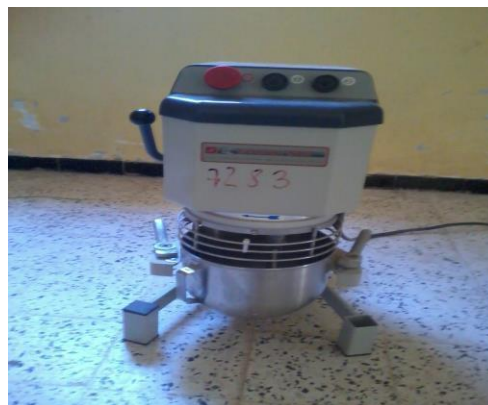
Figure III.2. Malaxeur utilisé pour la confection des éprouvettes
