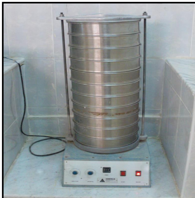
Figure II.7 : Appareillage pour l'analyse granulométrique par tamisage.
