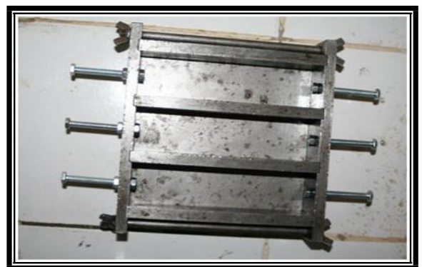
Figure III.4 : Moules utilisés pour l'essai de variation dimensionnelle.
