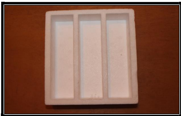
Figure III.3 : Moules utilisés pour l'essai mécanique
