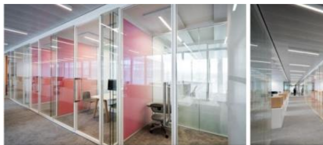
Figure V-8: parois avec panneaux aveugle en verre laqué et verre magnétique. Source : cour master2 « le développement durable ».
