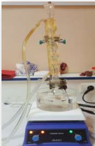
Figure III.1 : Montage expérimentale utilisé pour la synthèse conventionnel
