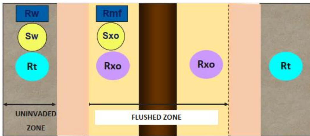
Figure II.6 : Distribution des résistivités dans les différentes zones d'invasion autour du puits.
