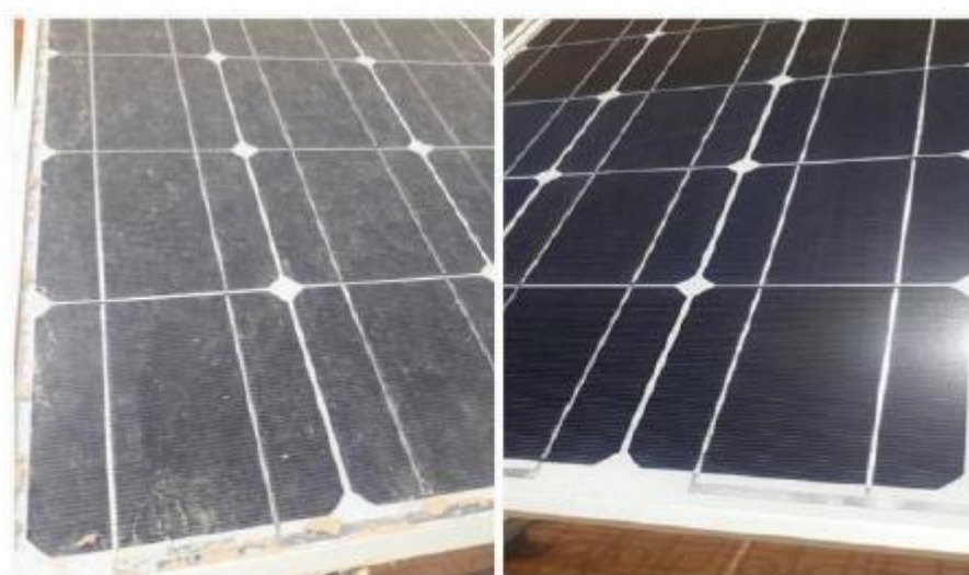
Figure II-16: Photographie de modules PV propres et poussiéreux [25].
