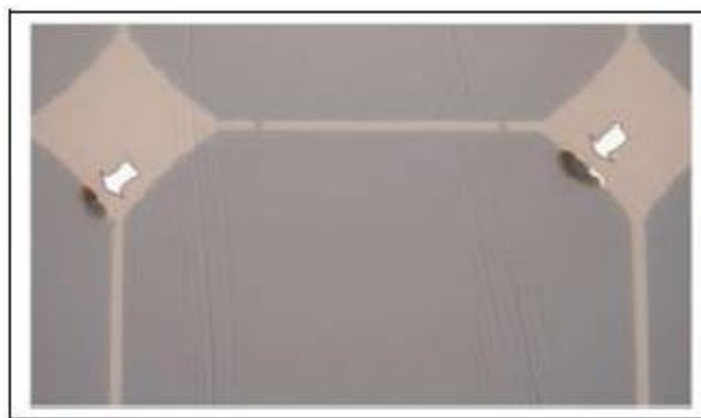
Figure II-6 : Module PV présentant des points chauds sur les bords des coins supérieurs. [14]
