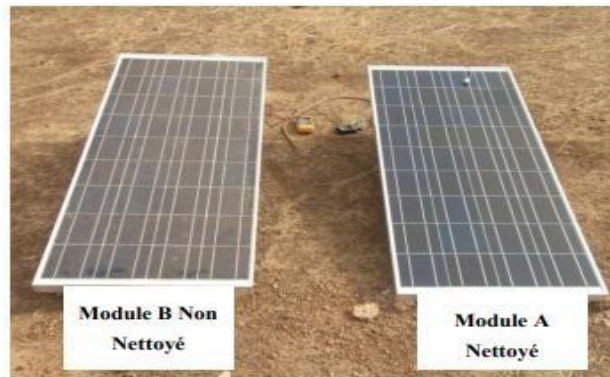
Figure III-9: Schéma d'Expérimentation de dépôt de poussière. [41]
