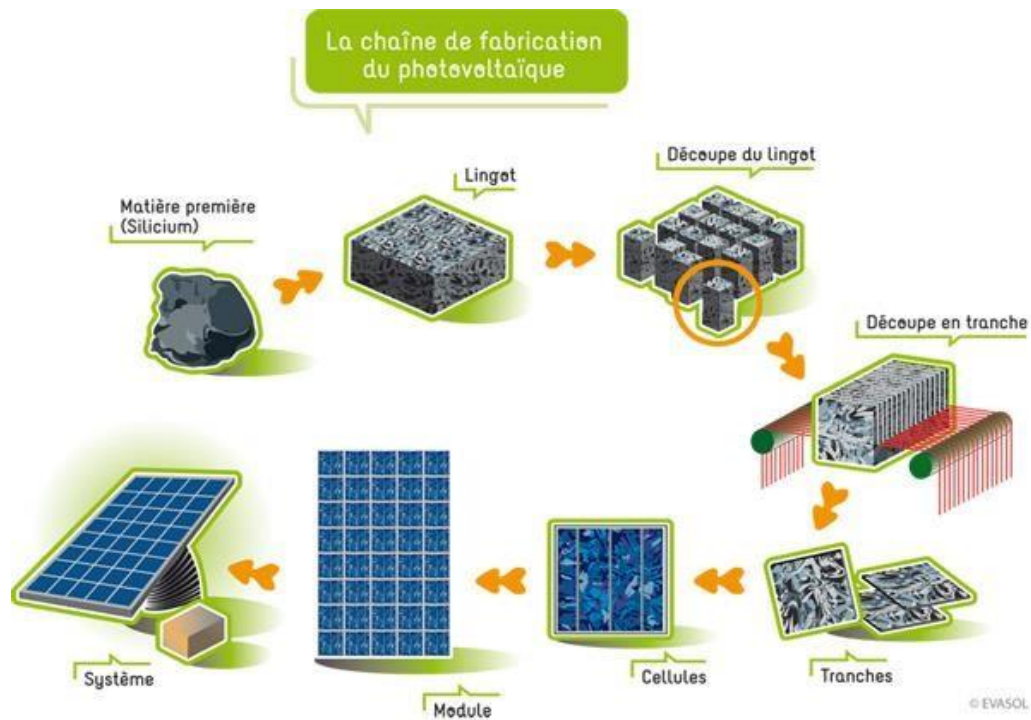
Figure I.5 : chaîne fabrication du photovoltaïque [9]
