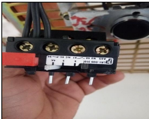
Figure (II.4) : Relais thermique et symbole [9]
