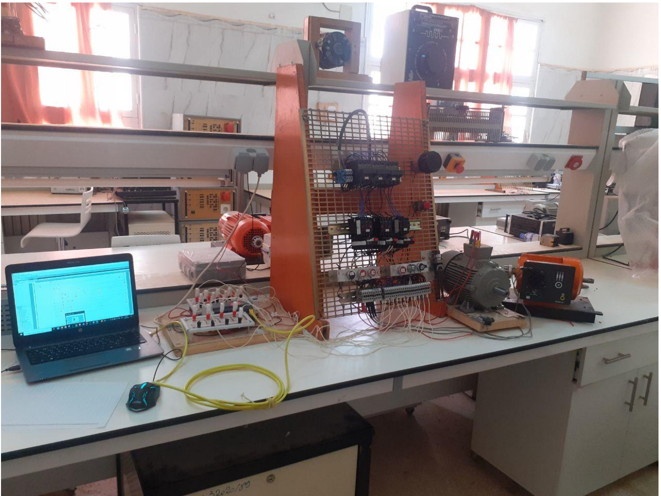
Figure II.15 : Réalisation de la station de pompage.
