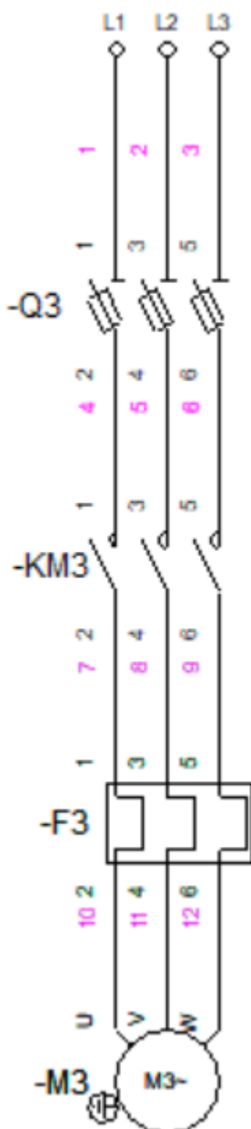
Figure (I.7) : Circuit de puissance du surpresseur.
