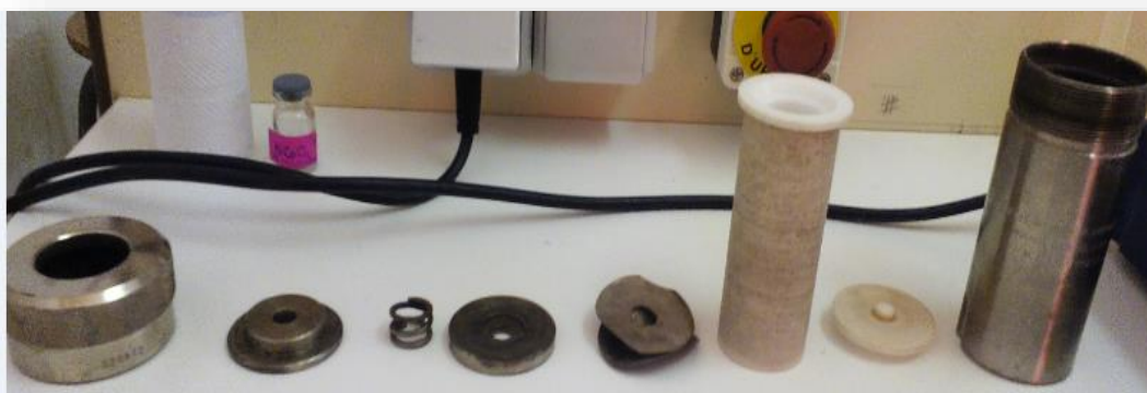
Figure II .1 : Photo du dispositif d'un autoclave (45ml) utilisé dans la synthèse hydrothermale.
