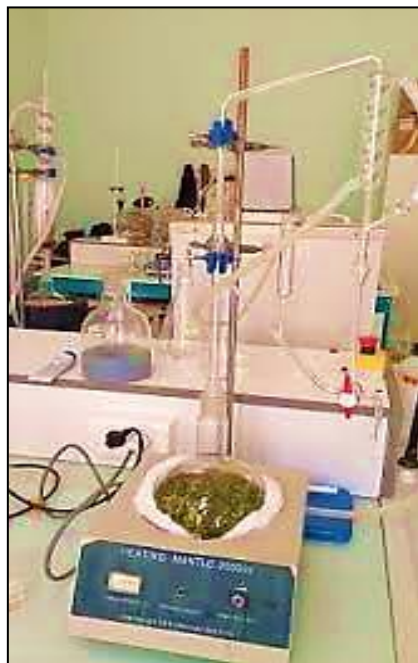
Figure 6 : Hydrodistillation avec extracteur type Clevenger
