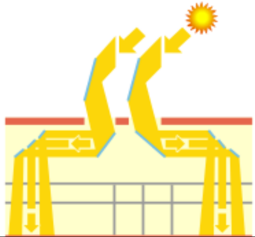
Fig:64_ un conduit solaire .source :www.energieplus-
