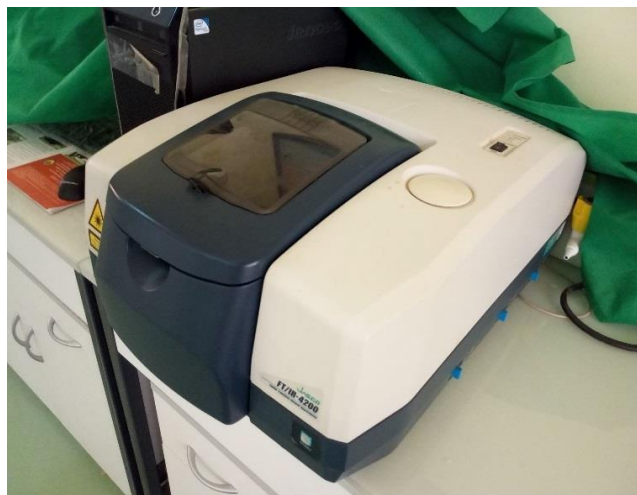
Figure II.17 : spectrophotomètre jasco FT/IR-4200
