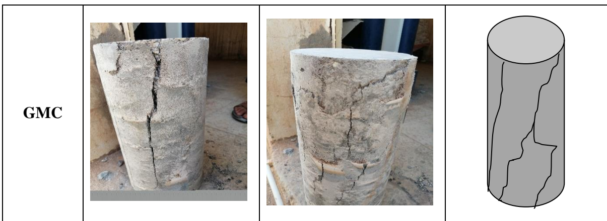
Figure 3.11: Mode de rupture du BAP confiné avec des grilles métalliques.
