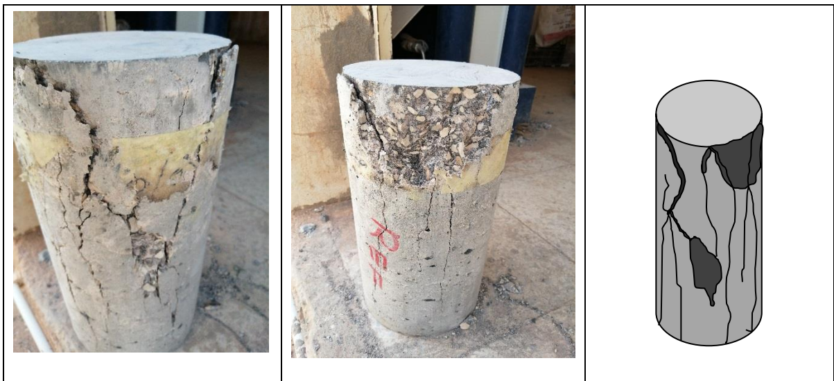
Figure 3.9: Mode de rupture de béton témoin.
