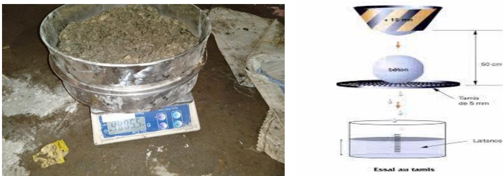
Figure 2.11: Essai de stabilité au tamis.
