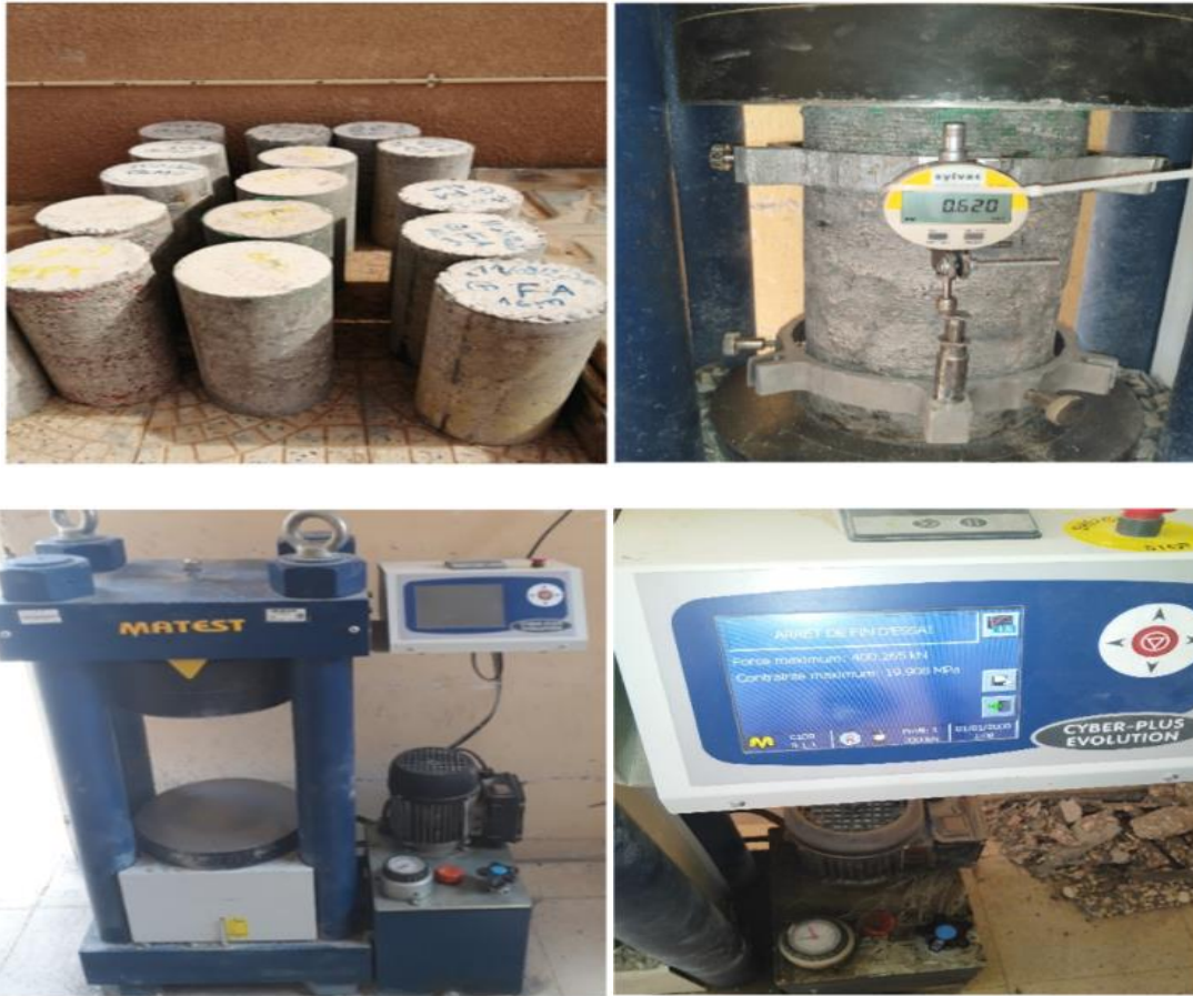
Figure 2.15: Procédure de l'essai de compression et dispositif de déformation vertical.
