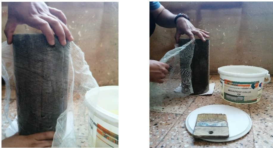
Figure 2.13 : Arrangements des grilles composites - techniques 2.
