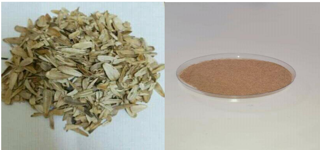
Figure II.3: L'adsorbant GT avant et après la préparation.
