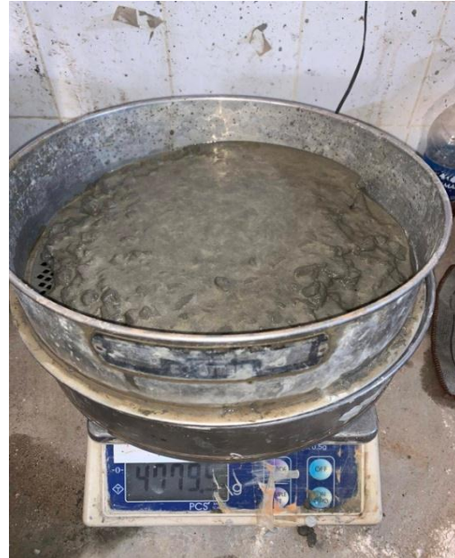
Figure 2.11. Essai de stabilité au tamis.
