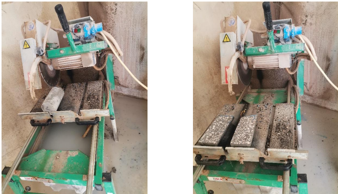
Figure 2.18 : Découpage des éprouvettes.
