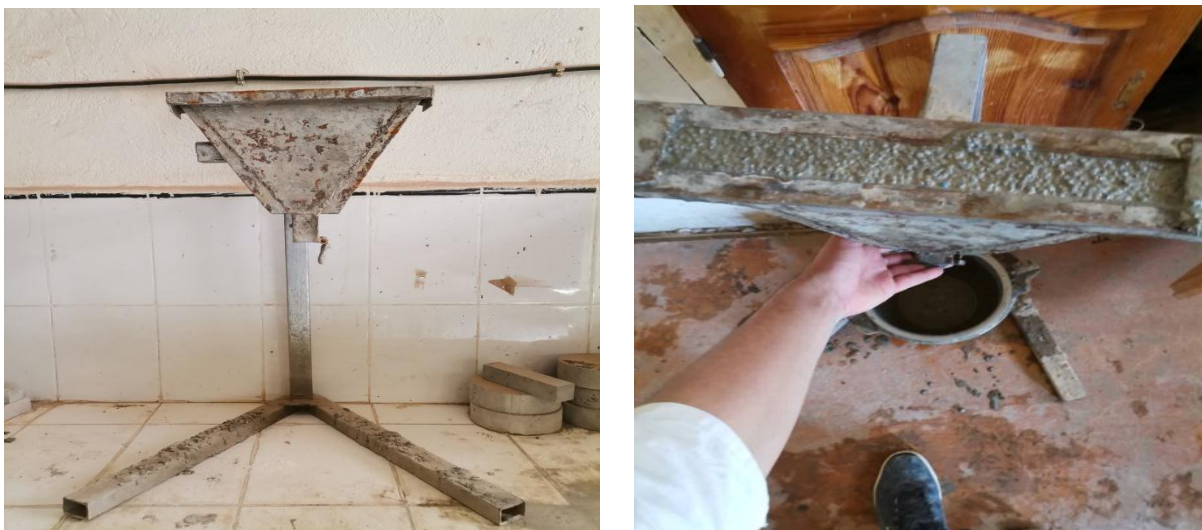
Figure 2.8. Essai d'écoulement au mini-entonnoir en V.
