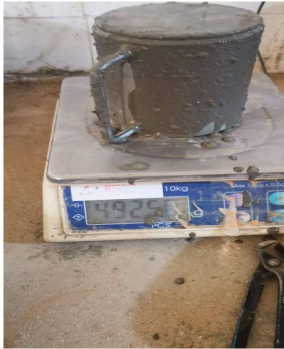
Figure 2.12. Mesure de la masse volumique du béton frais.
