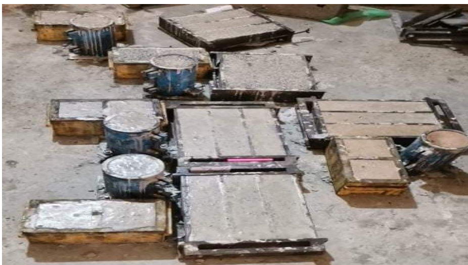
Figure 2.13. Confection des éprouvettes.
