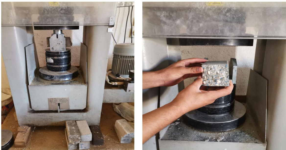
Figure 2.14. Détermination de la résistance à la compression.
