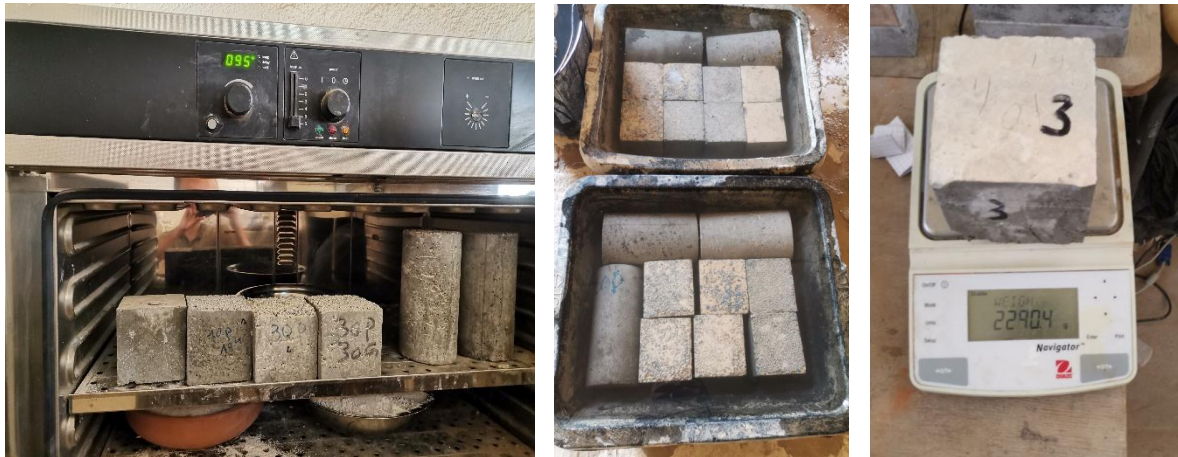
Figure 2.17. Absorption d'eau par immersion totale.
