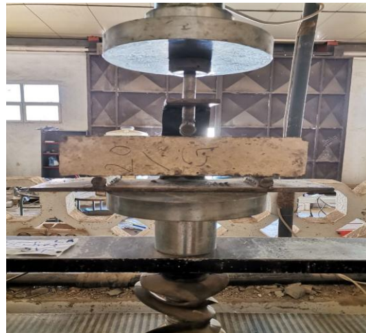
Figure 2.15. Essai de traction par flexion trois points.
