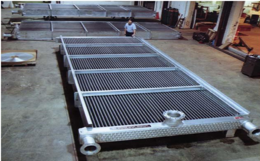
Figure 8 : Faisceaux d'aéro-réfrigérant en construction
