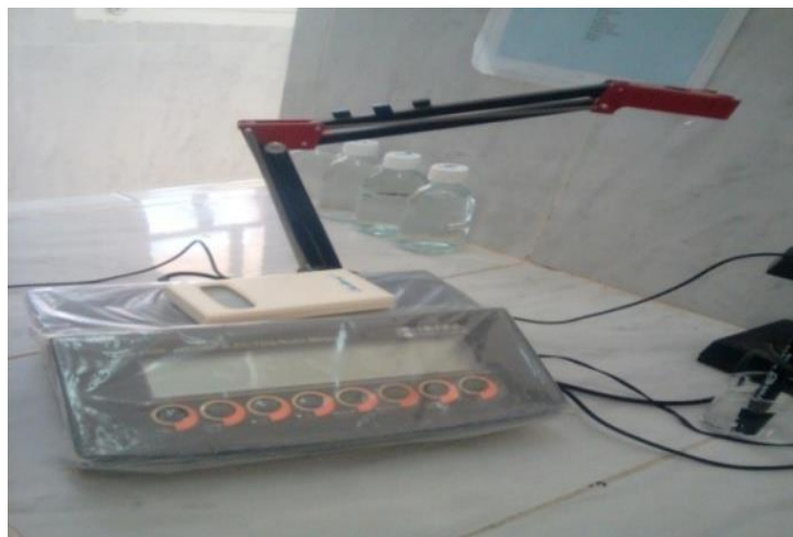
Fig.22: l'appareille multi- paramètre (HI 2550 pH/ORP et EC/TDS/NaCL Meter de marque Huch).
