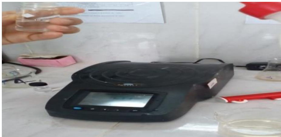
Fig.3: Spectrophotomètre UV visible utilisé pour la détermination du taux des nitrates.
