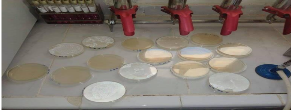
Fig.4: Photo montre les boîtes de pétri collé par le milieu TGEA pour dénombrement des germes totaux.
