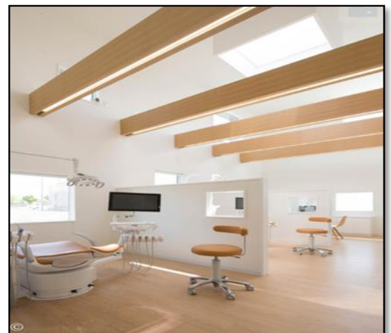
Figure 60: L'intégration des lumières dans les structures dans la clinique dentaire Yokoi. Source : https://www.archdaily.com/616874/yokoi-dental-clinic-iks-design-msd-office
