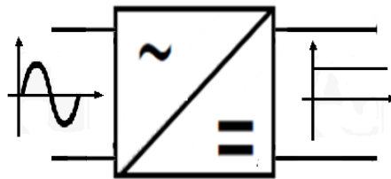
Fig.III.1 : Symbole d'un redresseur.
