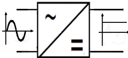
Fig.II.2 : Symbole d'un redresseur.
