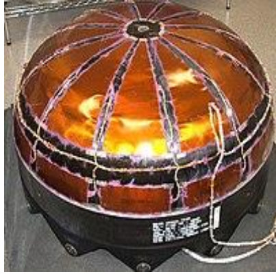
Fig I.4: Réservoir sous pression composite surenveloppé avec doublure en titane [1].
