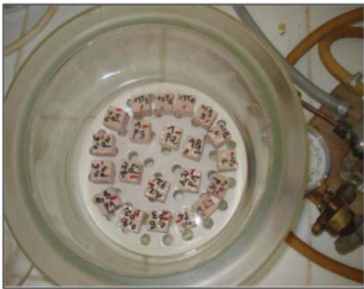
Photo II.8 : Dispositif et échantillon utilisés pour l'essai d'accessibilité à l'eau.
