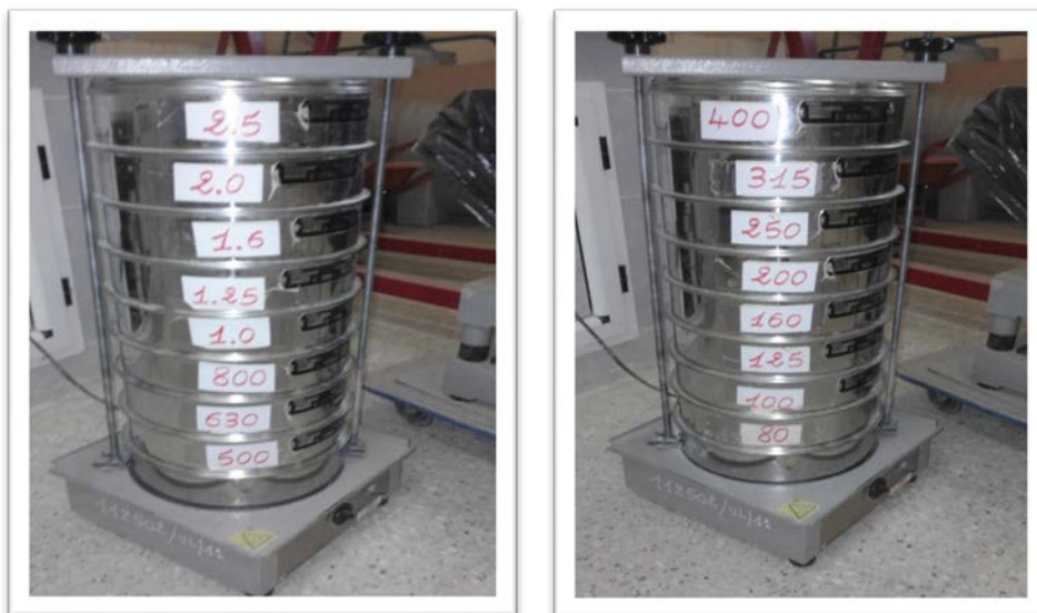
Photo II.2 : Appareillage de l'essai d'Analyse granulométrique par tamisage.
