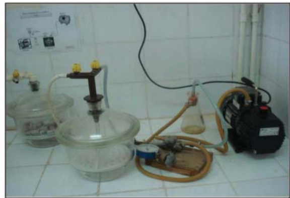
Photo II.8 : Dispositif et échantillon utilisés pour l'essai d'accessibilité à l'eau.
