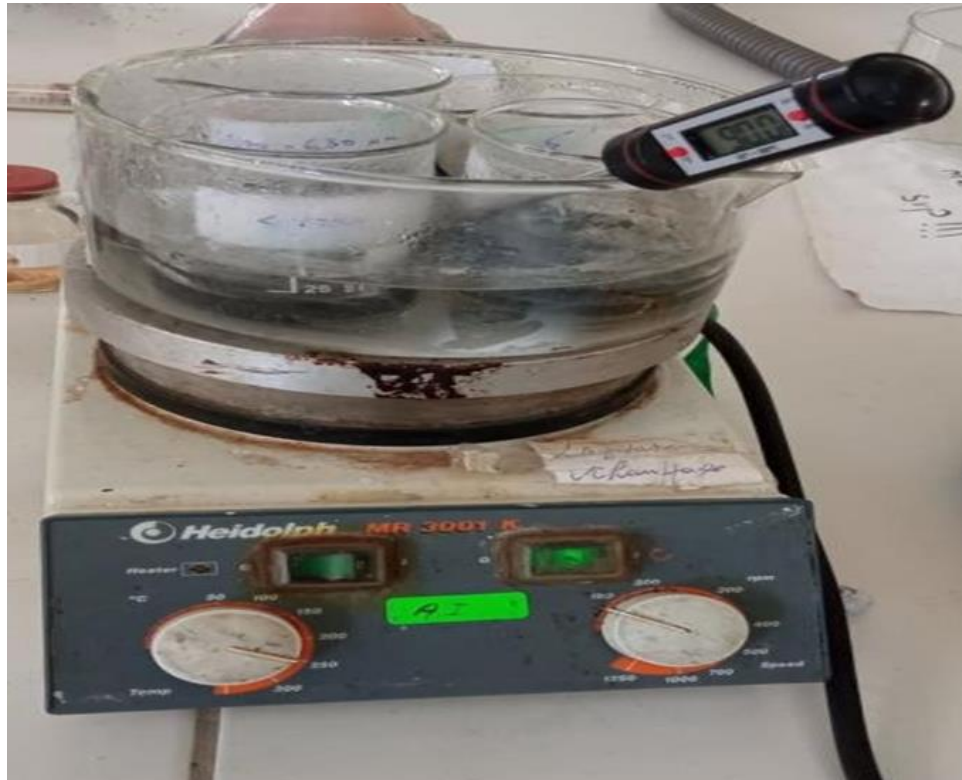
Figure I.2 : Schéma du protocole opératoire pour l'étude de la régénération chimique par une solution d'acide chlorhydrique HCl à différentes concentrations.
