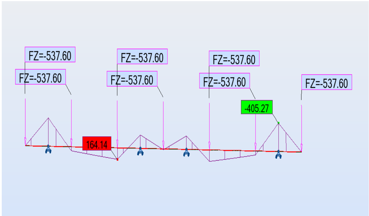
Figure VII-2 : diagramme du moment à l'ELS dans l'entretoise (disposition 1)
