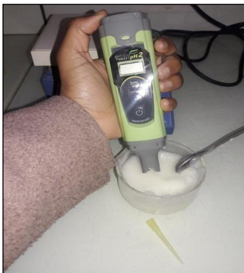
Figure III.10 : Mesure par le pH mètre
