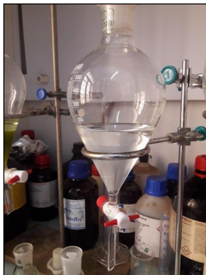
Figure II.5 : Ampoule à décanter contenant de phase organique et de phase aqueuse
