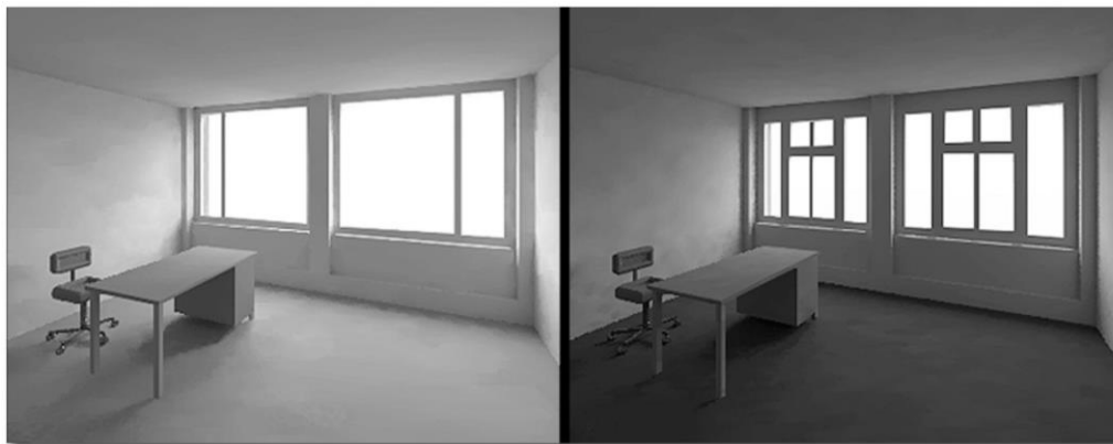
Fig VI.11 : Influence de la menuiserie sur la pénétration de la lumière naturelle La simplification des systèmes d'ouverture permet d'augmenter de façon notable la quantité de lumière transmise
