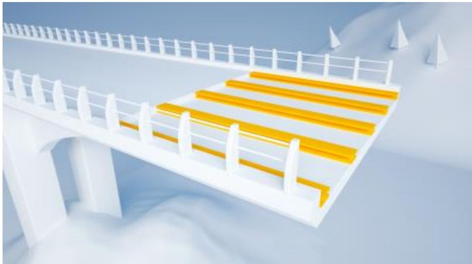
Figure I.10. Pont à poutrelles enrobées.
