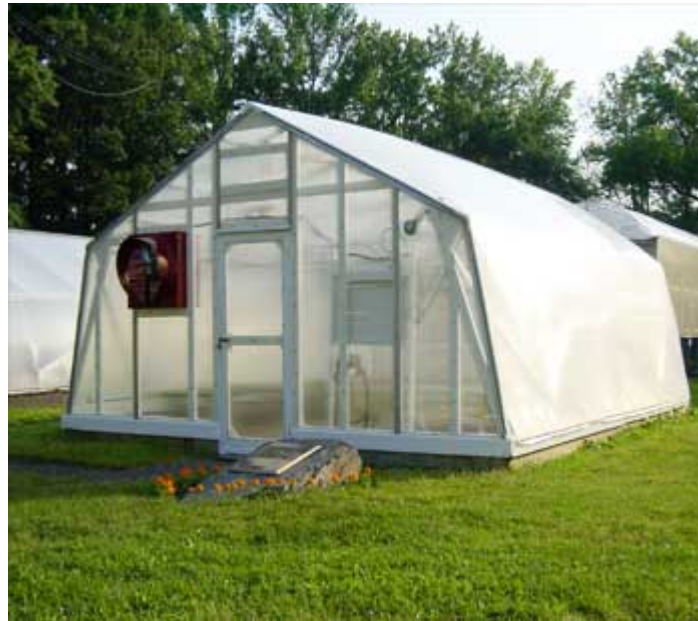
Figure 12: a) structure métallique constituée de barres peintes en blanc et relié par des noix en métal inoxydable. b) Serre agricole recouverte d'un film en polyéthylène en cour d'exploitation
