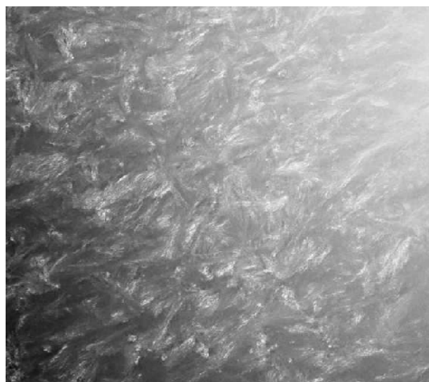
Figure 9: Cristallites dans du polyéther-éther-cétone (microscopie électronique)
