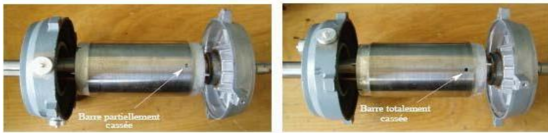
Figure I.12 Défaut d'une barre cassée
