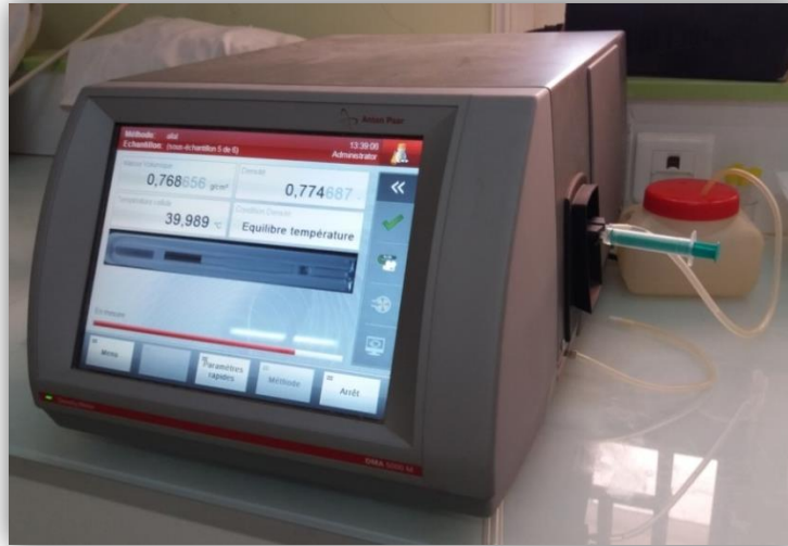
Figure II.1.1. Photo du densimètre Anton-Paar 5000 utilisé pour les mesures des densités.
