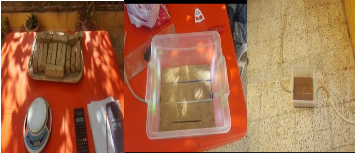
Photo III.14 : Différentes étapes de l'essai d'absorption capillaire
