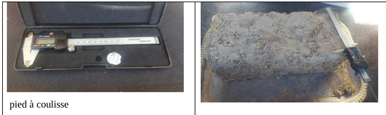
Photo III.12 : Technique de mesure du retrait volumique
