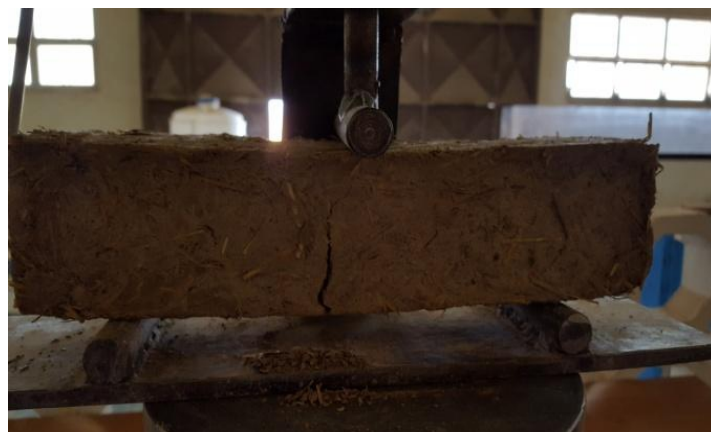
Photo III.13 : Dispositif pour l'essai de traction
