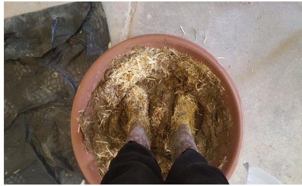
Photo III.8 : Malaxage du matériau (Chaoui Lina, 2017)
