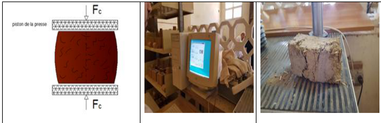
Figure III.5 : Dispositif d'écrasement à la compression.
