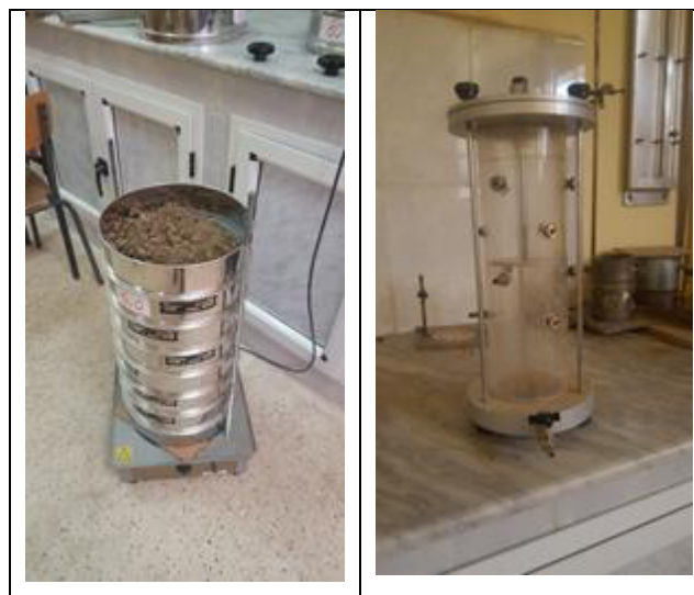
Photo III.3 : Matériels d'essai d'analyse granulométrique par tamisage et par Sédimentométrie,[EN933-1 et NF P 94-057].
