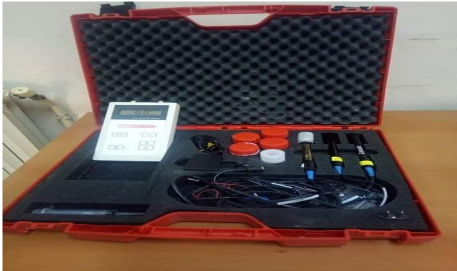
Figure (10) : Appareil multi paramètre de mesure WTW.
