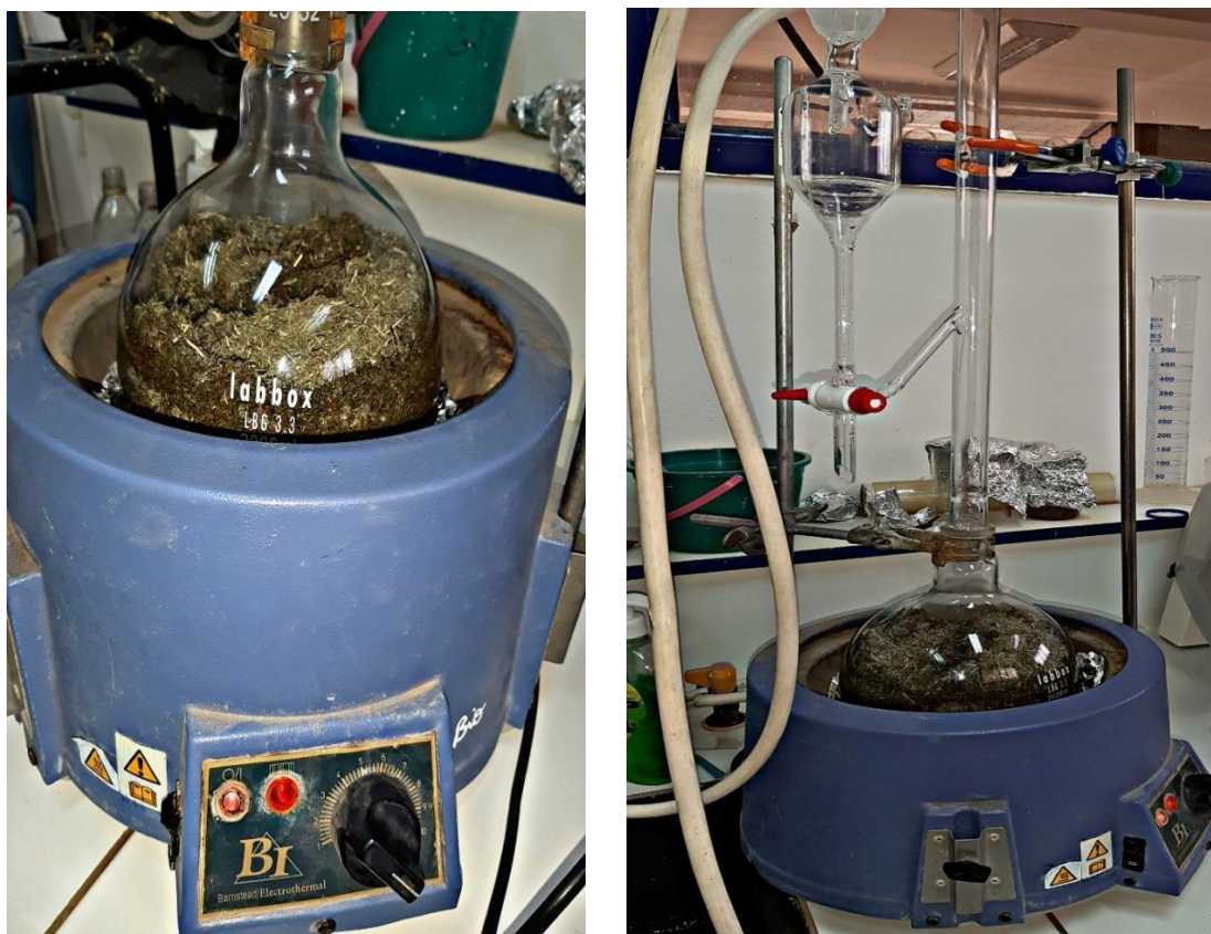
Photo 7 : Appareil Clevenger d'extraction des huiles essentielles par hydro distillation (Photo personnelle., 2022).
