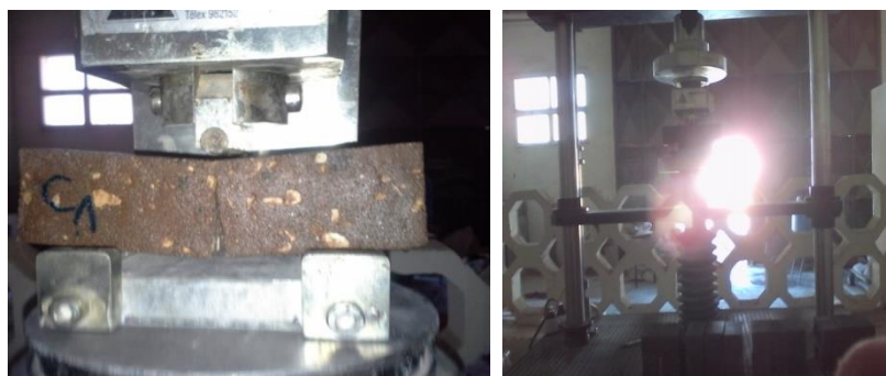
Figure III-4. Dispositif pour l'essai de résistance à la flexion à 3 points
