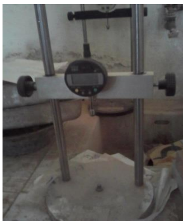
Figure III-6. Réfractomètre muni d'un comparateur de mesure de la variation de longueur
