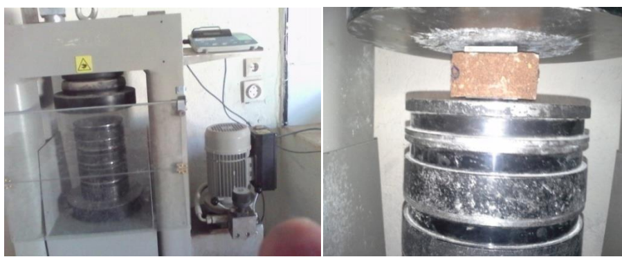
Figure III-5. Dispositif de rupture à la compression
