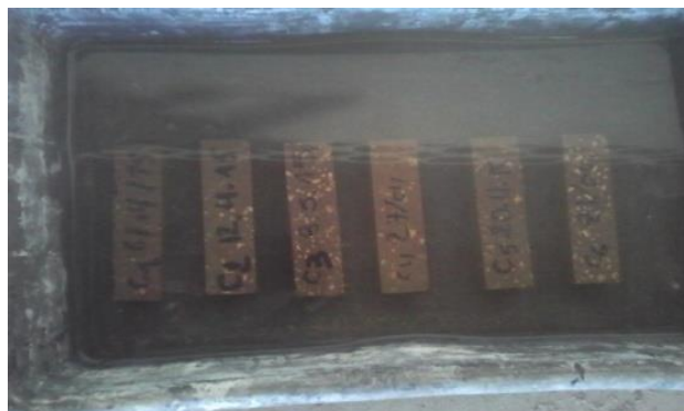
Figure III-7. Montage expérimental utilisé dans l'essai d'absorption par immersion
