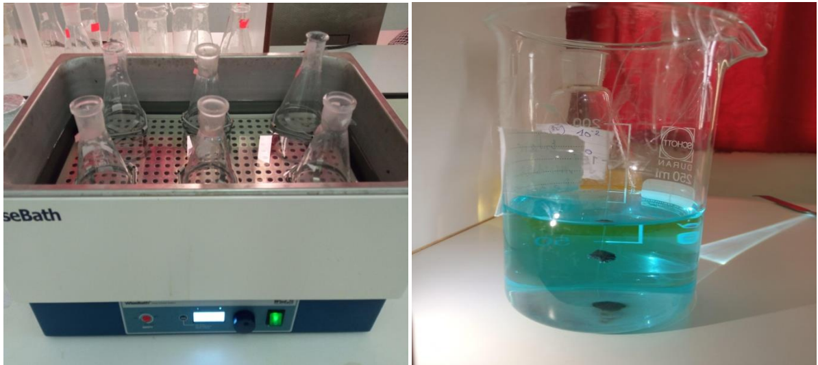
Fig.5 Dispositif expérimental pour l'étude gravimétrique
