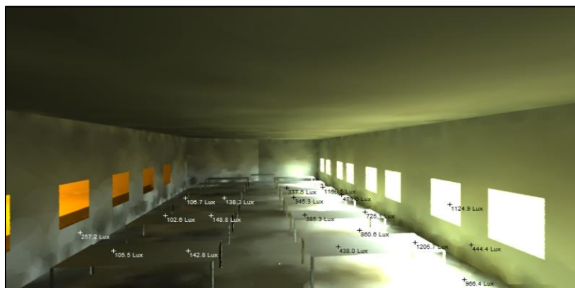
Figure V- 25: Mesure de niveau d'éclairément du 21 Décembre à 09 h ciel dégagé cas initial. Source : Radiancia traité par l'auteur
