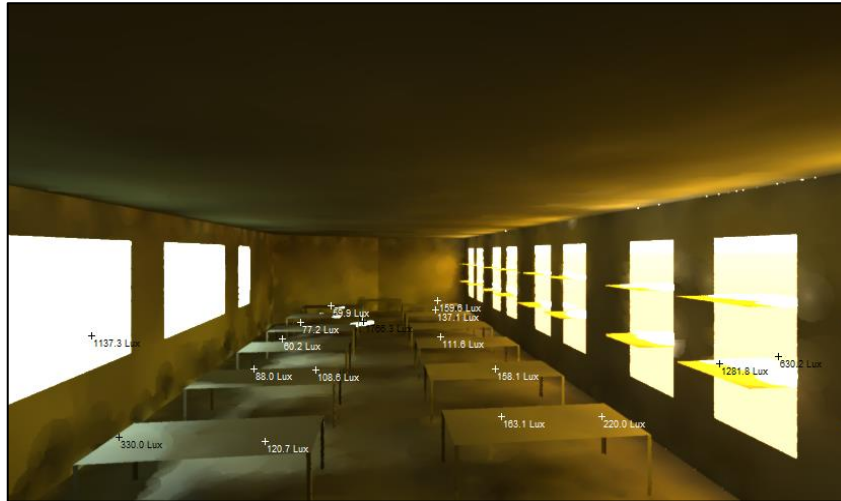
Figure V- 67: Mesure de niveau d'éclairage du 21 Décembre à 15 h ciel dégagé cas amélioré2. Source : Radiance
