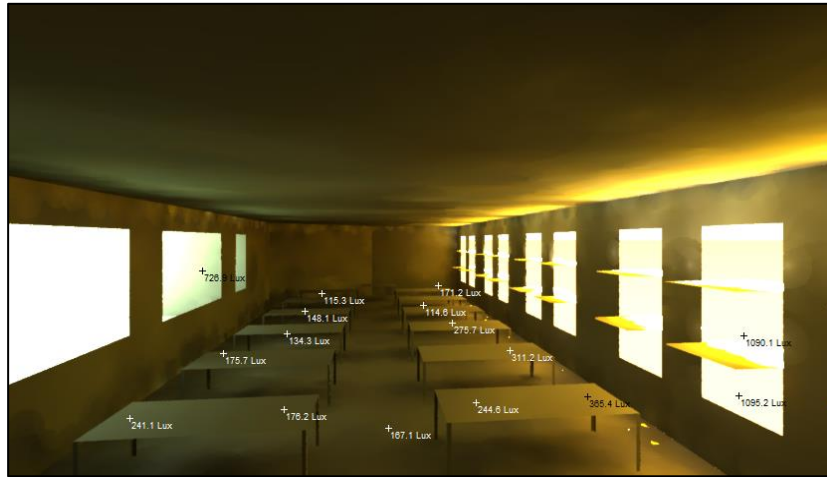
Figure V- 73: Mesure de niveau d'éclairage du 21 Juin à 12 h ciel dégagé cas amélioré2. Source : Radiance
