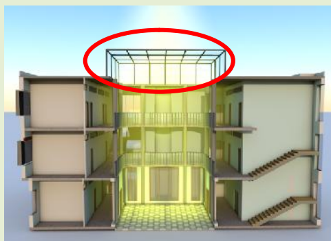
Figure 50 coupe présente l'éclairage zénithal (source l'auteur)
