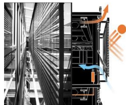
Figure 24 une photo de l'ordinateur automatique volets et un schéma en coupe de la paroi environnementale. (source AIA)
