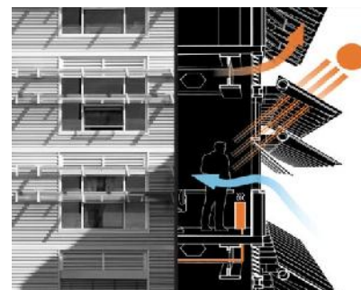
Figure 25 une photo des ombrelles de verre et un schéma en coupe de la paroi environnementale (source AIA)
