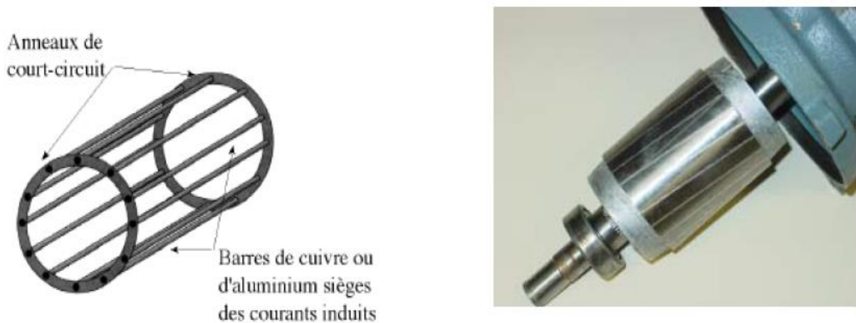
Figure 1.4 : Rotor à cage d'écureuil de machine asynchrone[06]
