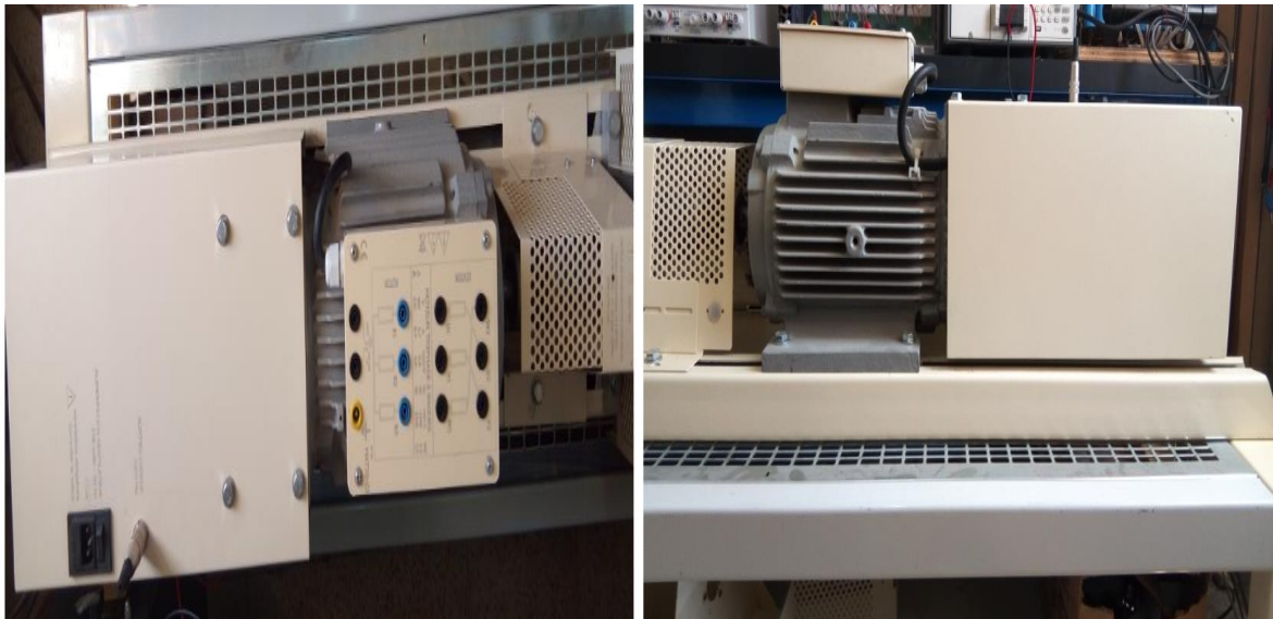
Figure 3.2 Machine asynchrone à rotor bobiné (Langlois-MAT20-C1)
