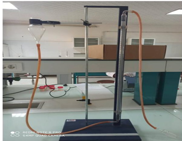
Figure 17. Dispositif de calcimètre de Bernard
