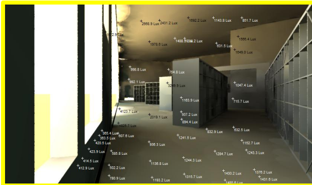
Figure 8-14 Mesure de niveau d'éclairage à ciel dégagé
