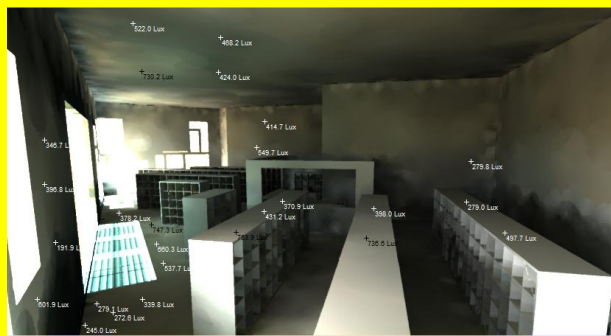
Figure 8-24 Mesure de niveau d'éclairage à ciel dégagé source : auteur
