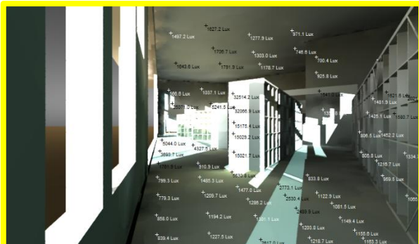
Figure 8-6 Mesure de niveau d'éclairage à ciel dégagé
