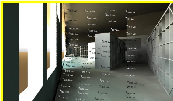
Figure 8-10 Mesure de niveau d'éclairage à ciel dégagé
