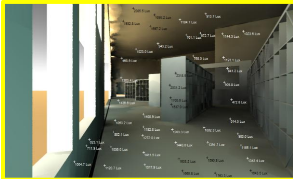
Figure 8-12 Mesure de niveau d'éclairage à ciel dégagé
