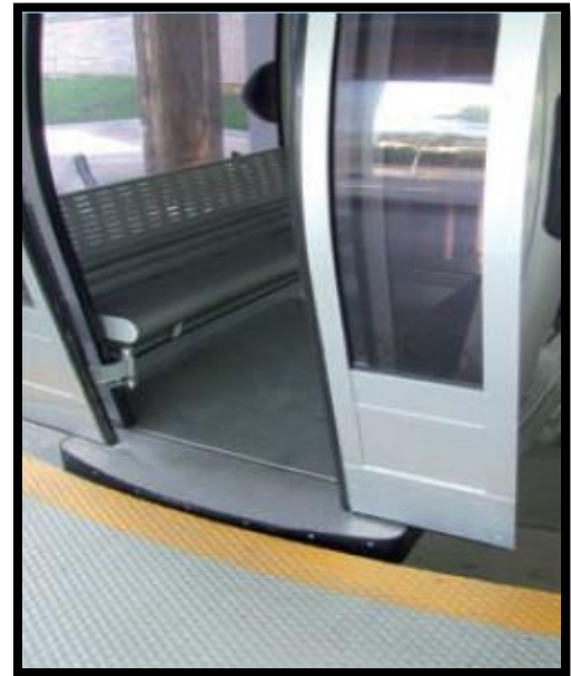
Figure 232 : porte d'un téléphérique avec un vitrage intelligent Source : livre Transport par câble aérien en milieu urbain (Service Technique des Remontées Mécaniques et des Transports Guidés (STRMTG)) page 67
