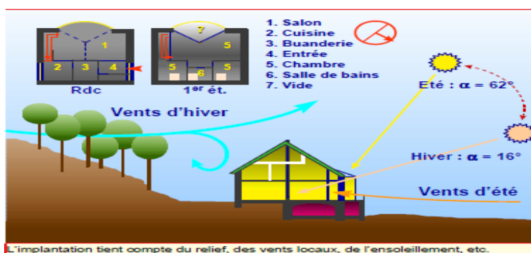
Figure N04 : L'implantation tient compte du relief des vents locaux, de l'ensoleillement, etc. (A.DE HERDE, A. LIEBARD. 2005).
