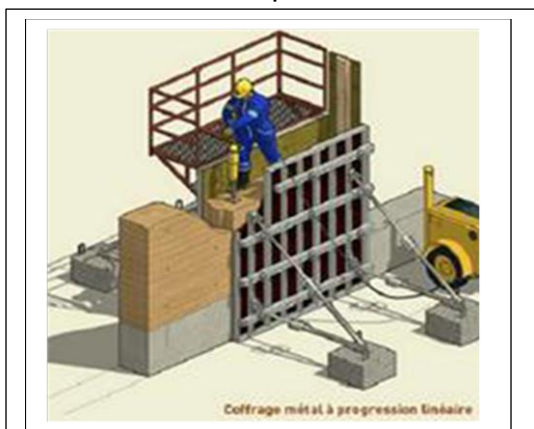
Figure n5 : photo qui représente l'exécution de mur pisé. Source : Google image.
