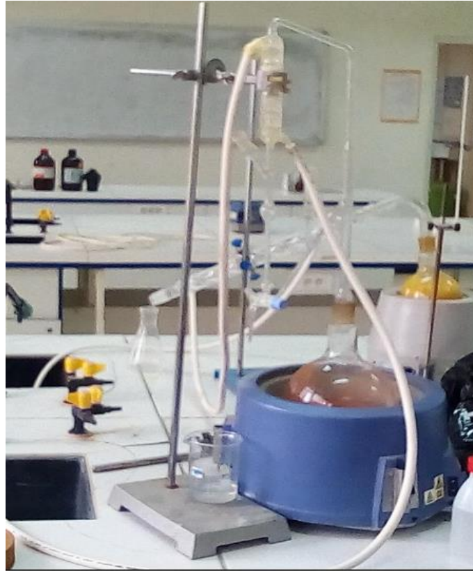
Photo 4. Dispositif d'extraction des huiles essentielles : Clevenger
