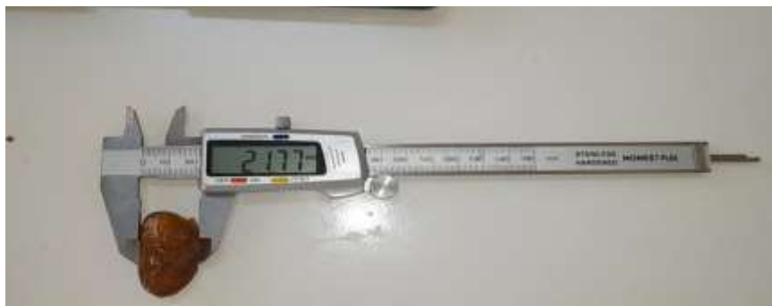
Figure 15 : Illustrative du pied à coulisse (Photo original, 2023)
