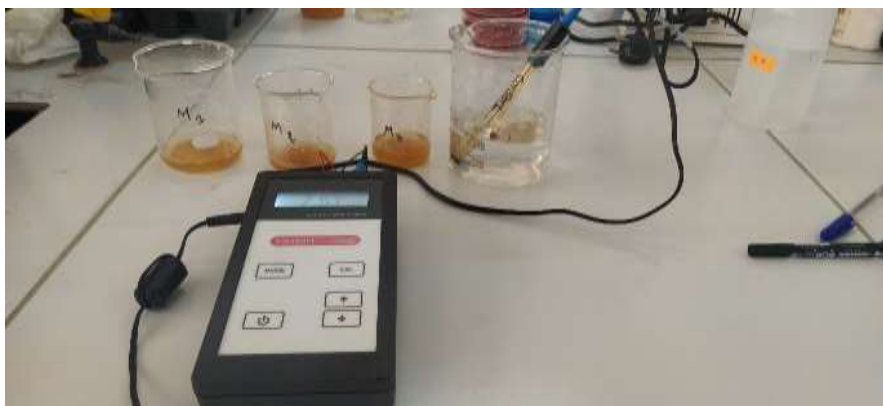
Figure 16 : pH – mètre et les solutions à analyser (photo original 2023)
