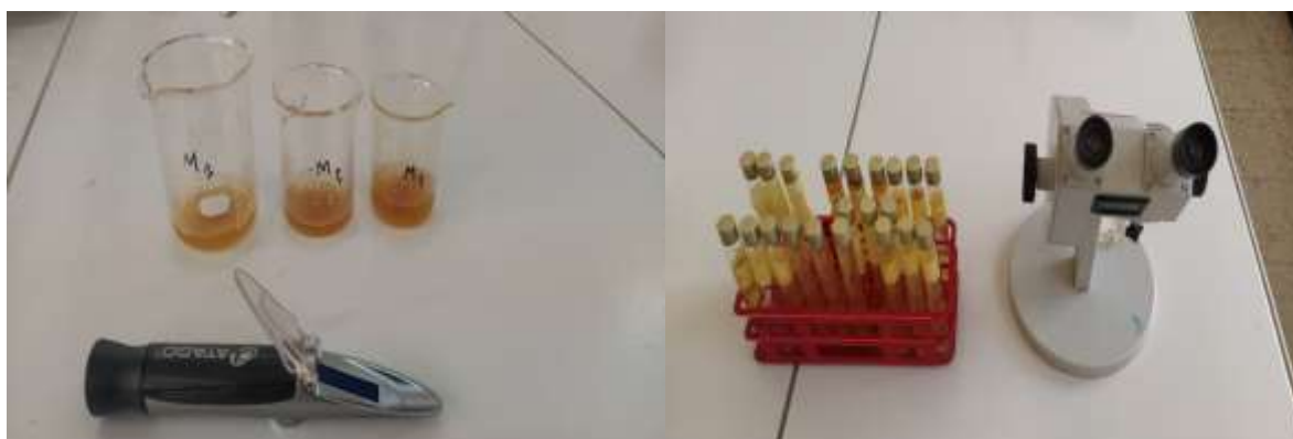
Figure 17 : les deux types de refractomètre utilisés pour la détermination du sucre (photo original 2023)
