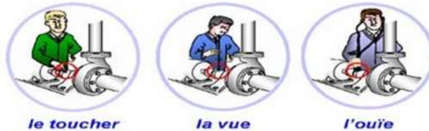
Figure 3.5 : mesures des vibrations par l'expérience humaine.
