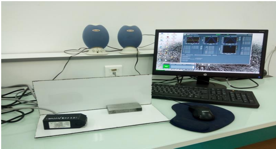
Figure III-1 -Dispositif de mesure par bruit Barkhausen (Labo LPM Laghouat)
