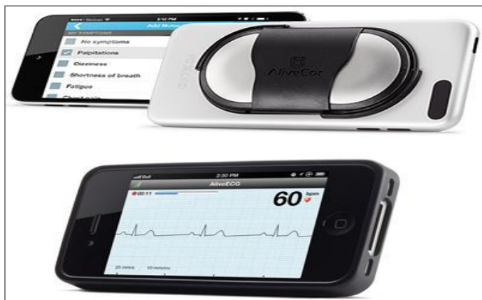
Figure 1.8 : Exemple d'un système de monitoring cardiaque d'AliveCore avec capteur biométrique et application pour iPhone.
