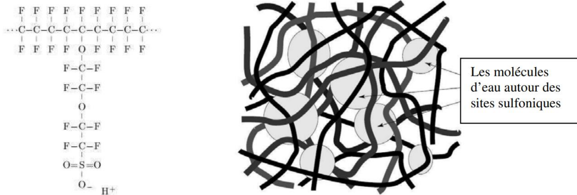
Figure I.4 : Formule chimique et structure d'une membrane du type Nafion
